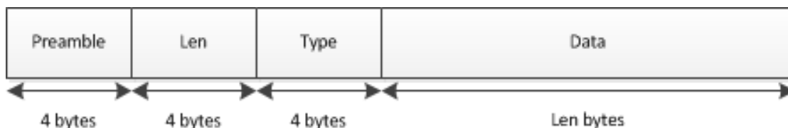
Рисунок 4 – Структура пакета UDP
