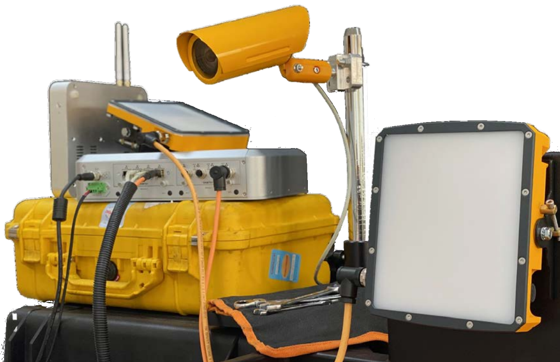
Система контроля периметра из двух радаров, камеры и промышленного компьютера
