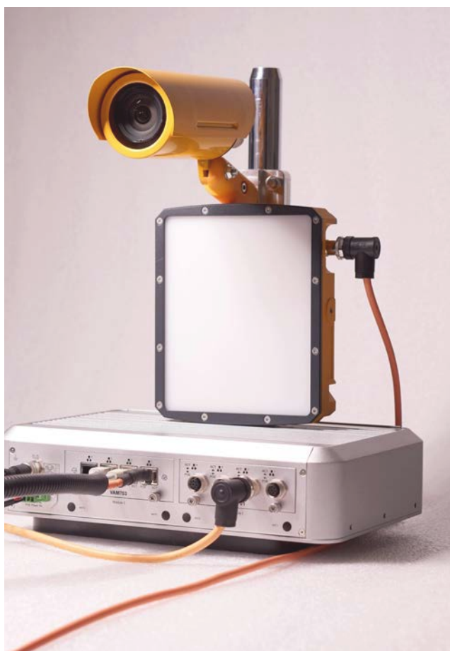
Универсальный радар CPRR в системе с видеочамерой и промышленным компьютером
